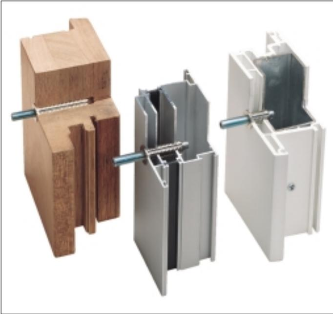
La technique de fixation avec douille à expansion permet une solution pratique pour montage unilatéral en surface sur portes en bois, à châssis métallique ou PVC. Selon le type de porte, la longueur optimale de la douille est à convenir. Celle-ci existe en longueurs de 20, 34 et 46mm.
