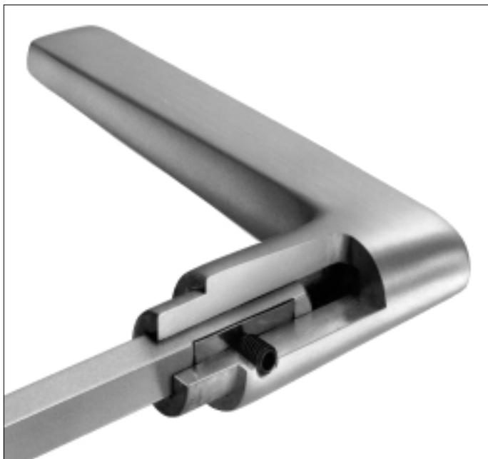
La tige carrée Stabil FSB recourt à la tradition de ses précurseurs, la tige à FSB et la tige crantée FSB. Ce qui est nouveau c'est le dispositif de compensation de tolérance à ressort qui est perforé lors de la pose par la l'insert vis pointeau en forme d'un goujon fileté.
